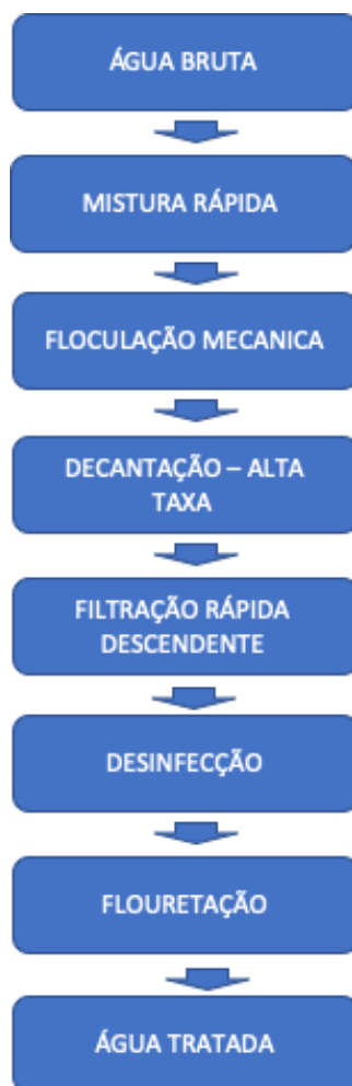
Figura 12 - Fluxograma da ETA 1
