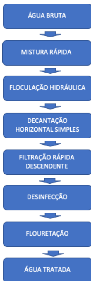
Figura 14 – Fluxograma da ETA - 2
