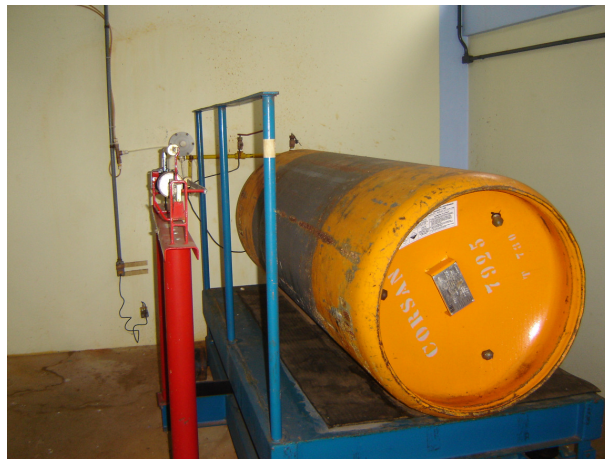
Figura 65: Cilindro de 900 kg de cloro.
