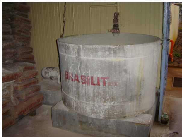
Figura 49: Estoque de cal e tina de preparação da solução.
