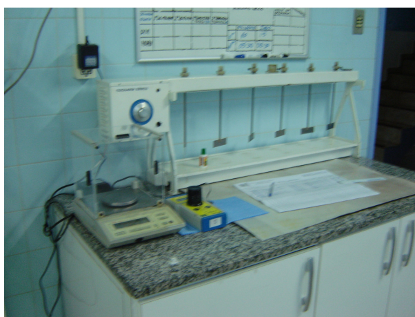
Figura 45: Jar teste e outros equipamentos.
