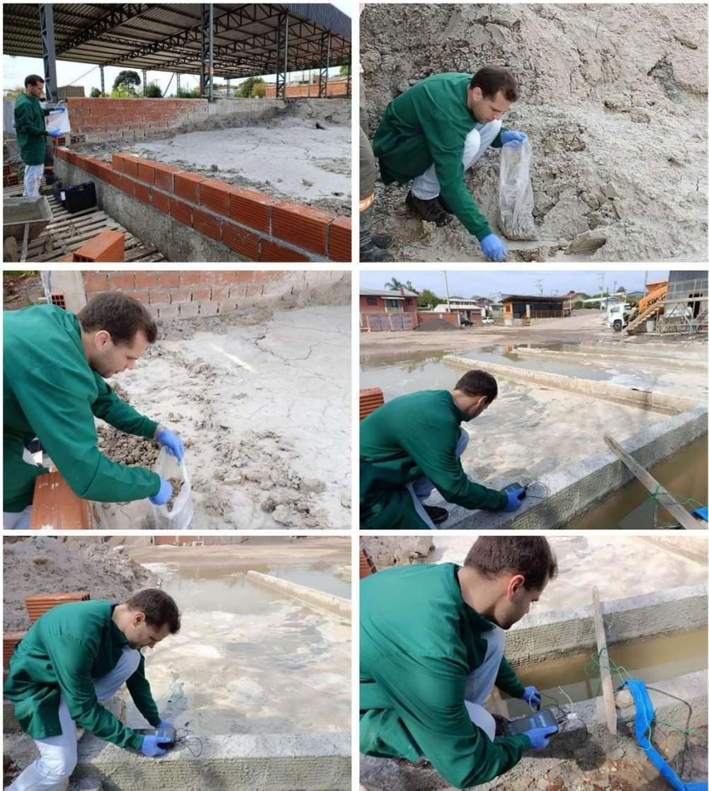
Fotos 01 a 06 – Coleta de lodo gerado nos decantadores da empresa para fins de caracterização e determinação de resíduo sólido industrial e consequente armazenamento e destino final.
