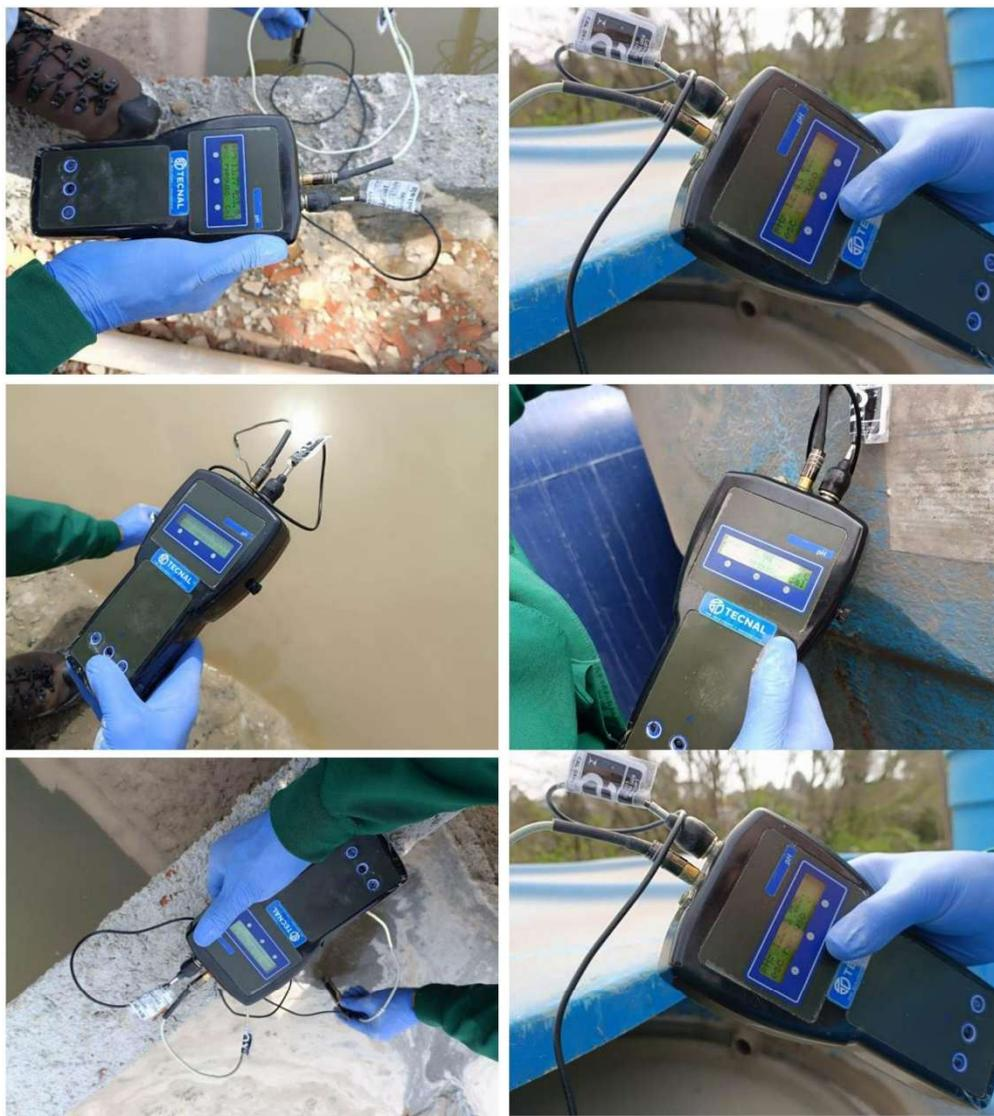
Fotos 01 a 06 – No mesmo dia foram feitas análises nas caixas de reuso de água com a medição de *ph* (Potencial Hidrogeniônico). Os resultados foram de 12 a 14 de *ph* demonstrando uma água de caráter bastante básico, advindo dos próprios materiais utilizados na fabricação de concretos, podendo ser utilizado para os fins de lavagem de equipamentos (água de reuso).
