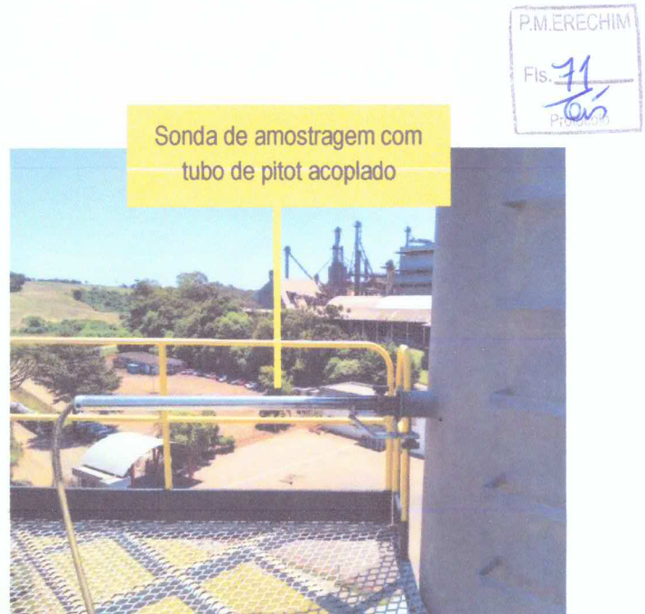
Figura 7: Sonda de amostragem acoplada ao flange de amostragem.
